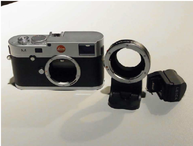
ライカ M ボディに、マウントアダプター、EVF を取り付ければ、レンジファインダー機の限界を超えた、マクロ撮影や超望遠撮影もライブビューで可能となる
