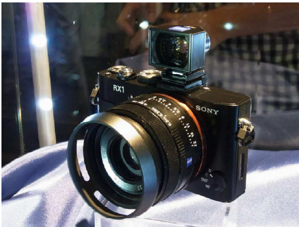
センサーを作るソニーらしくレンズ非交換で35mmフルサイズセンサーを搭載したコンパクト機「RX-1」
