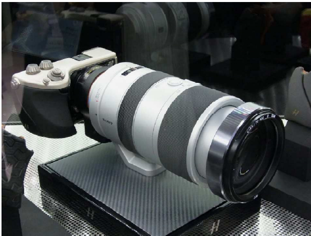
トランスルーセントミラーを組み込んだマウントアダプターを取り付け マウントフルサイズカバーのソニー G70 ~ 400mmF4-5.6 SSW レンズを装着
