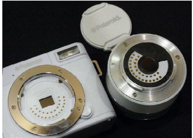
電気接点は26個。ボディ側撮像素子のようなもの、レンズ後部光学ガラスのようなものはすべてダミーである
