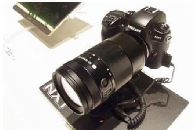
APS-C 判初の裏面照射方式を採用、2,800万画素のサムスンNX-1。レンズは、新製品 50~150mmF2.8S ED OIS
